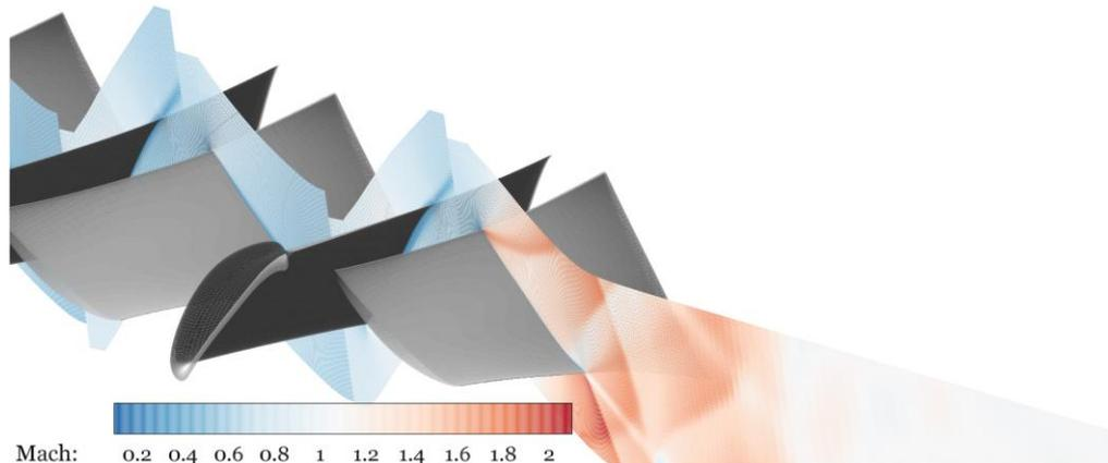
Mach-Zahl Verteilung nahe Mittenschnitt eines dreistufigen Axialverdichters (Franke, 2018)
